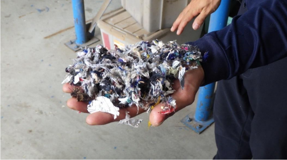
破碎後の原料状況
